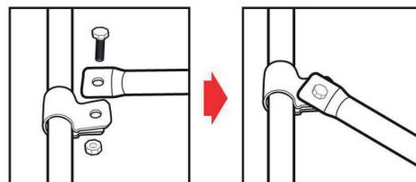
Pour un serrage optimum des renforts et montants de porte, positionner la partie écrasée du tube sur l'extérieur du collier.
