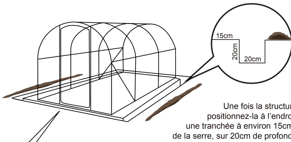
Une fois la structure de la serre montée, positionnez-la à l'endroit souhaité et creusez une tranchée à environ 15cm des bords extérieurs de la serre, sur 20cm de profondeur et 20cm de large.
