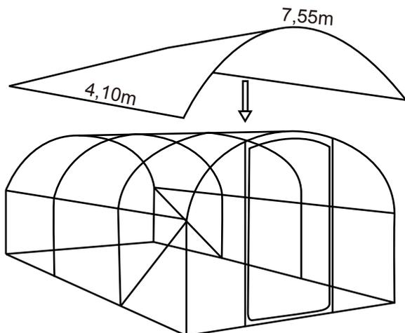
**1/** Installez la bâche de couverture sur la structure. Prenez soin de positionner le surplus de bâche de chaque côté dans les tranchées et couvrir légèrement de terre afin de créer une première tension.
